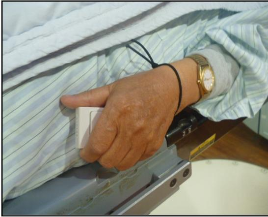
無線緊急呼叫鈴為一簡易的無線裝置，訊號發射器之大小適可讓個案單手握持。配合生理監視器使用，可協助隔離空間內檢查或治療過程中的個案即時有效溝通、促進安全。
